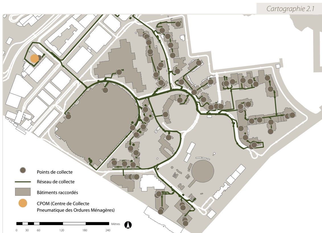
Réseaux de collecte pneumatique des ordures ménagères du quartier Fontvieille
